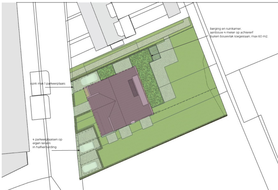
Afbeelding situatie, bouwenvelop met nieuwbouw (Bron Arcom)
