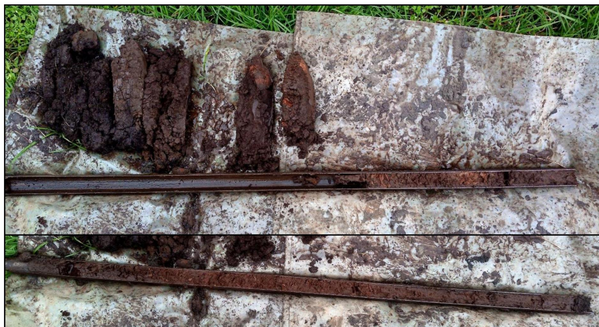
Boring 5. Boven: 0-100 cm -Mv. Onder: 100-200 cm -Mv.
