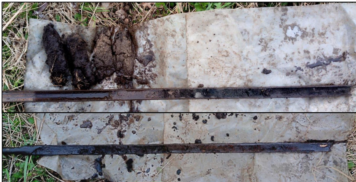
Boring 1. Boven: 0-100 cm -Mv. Onder: 100-200 cm -Mv.
