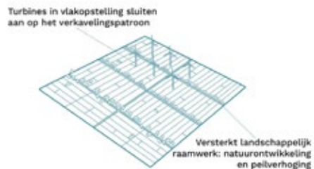
Ontwerpprincipe 2: windturbines in vlakopstelling als clusters in enkele weidelandschappen
