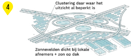
Ontwerpprincipe 4: zonnevelden op knooppunten en binnen overhoeken
