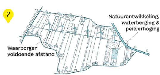
Ontwerpprincipe 2: windturbines in lijnopstelling langs weteringen in het veenweidelandschap met rivierinvloeden
