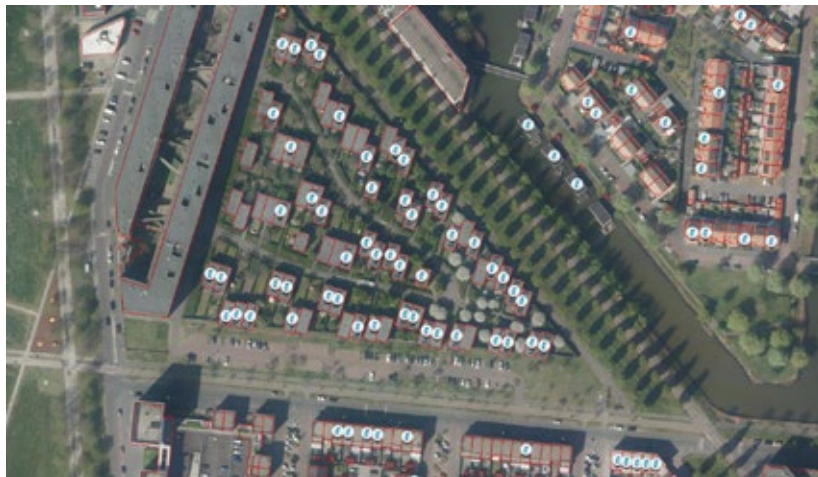
Figuur 2: Detectie zonnepanelen o.b.v. luchtfoto
