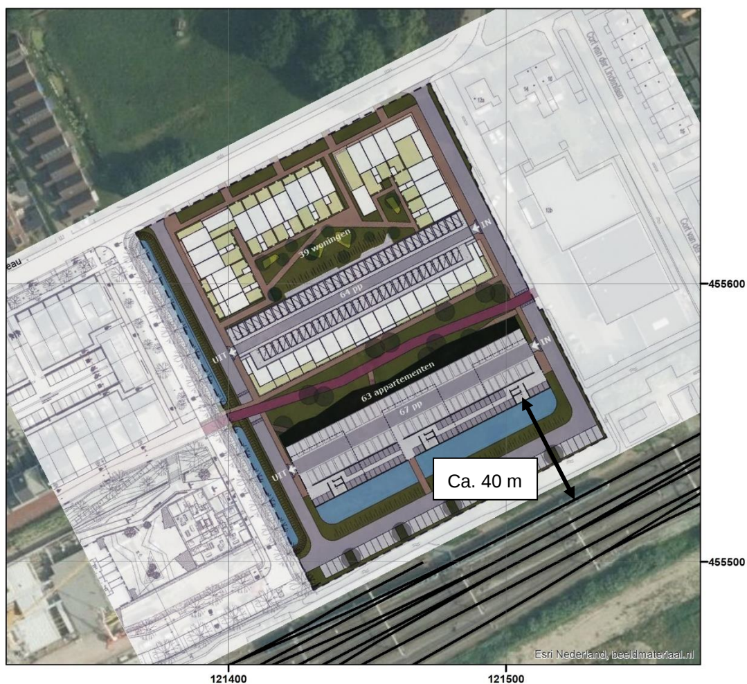
Figuur 6. Afstand tot de buitenste spoorstaaf
