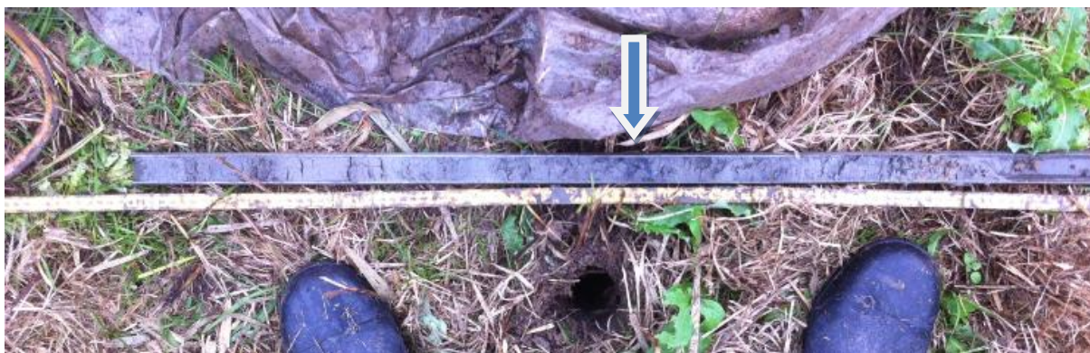
Opname van boring 13: gebandheid van klei en detritus in het zand. De pijl geeft een donkerkleuring aan die vermoedelijk een waterbodem betreft.
